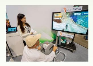
SilverMOVE是一款操作簡易的虛擬現實運動訓練系統,採用無線、可黏貼、經濟實惠的動作感應器,適用於各種器材,將傳統運動器材的升級程序輕便化,運動過程遊戲化,令長者的健身運動和殘障人士的康復運動更有樂趣。
